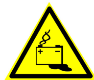
W 20 Обережно! Акумуляторні батареї
