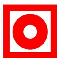
F 10 Кнопка увімкнення установок систем пожежної автоматики
