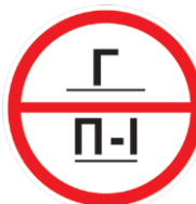
Знаки категорії приміщень - Г
