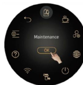
**3-й крок:** Перейдіть з центру екрана на глибоке промивання блока заварювання. Натисніть **OK**.
