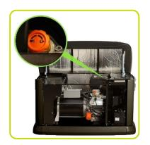
Примечание: Топливная труба должна быть рассчитана на полную нагрузку. Требуемое давление топлива на входе в генератор во всех диапазонах нагрузок 0.87-1.74 kPA (3,5-7 дюймов водяного столба) для природного газа, 2.49-2.99 kPA (10-12 дюймов водяного столба) для пропана.
