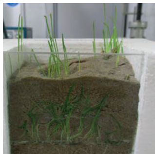
Проростання бур'янів через модифікований пісок FUS
