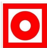
F 10 Кнопка увімкнення установок систем пожежної автоматики
