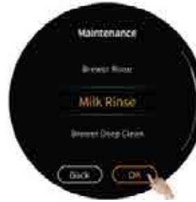
**4-й крок:** Відбувається вход до режиму швидкого промивання контуру молока. Натисніть OK для швидкого промивання контуру молока.
